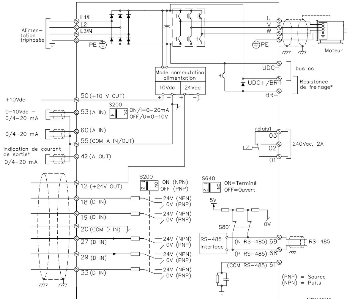
Illustration 1.6 Schéma indiquant toutes les bornes électriques
