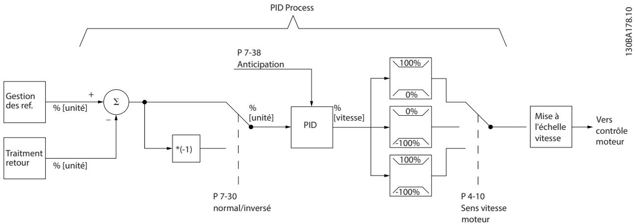
Illustration 2.23 Diagramme du régulateur PID de process
