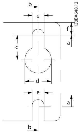
Illustration 7.16 Trous de fixation supérieurs et inférieurs
