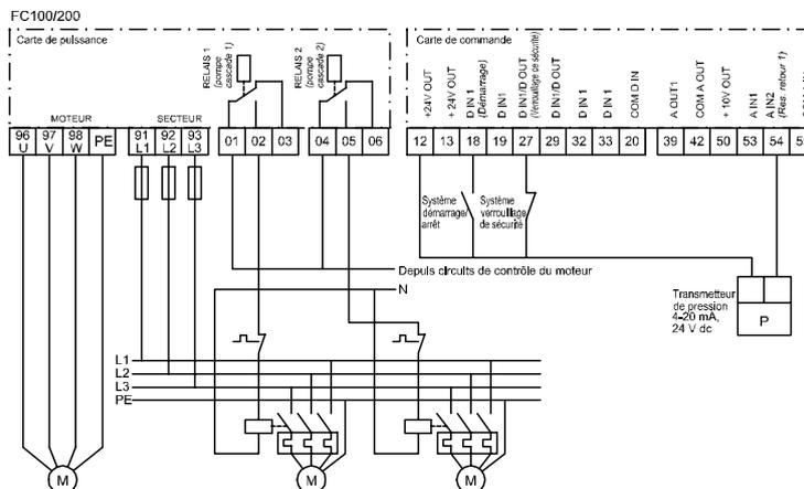
Illustration 7.11 Schéma de câblage du contrôleur de cascade
