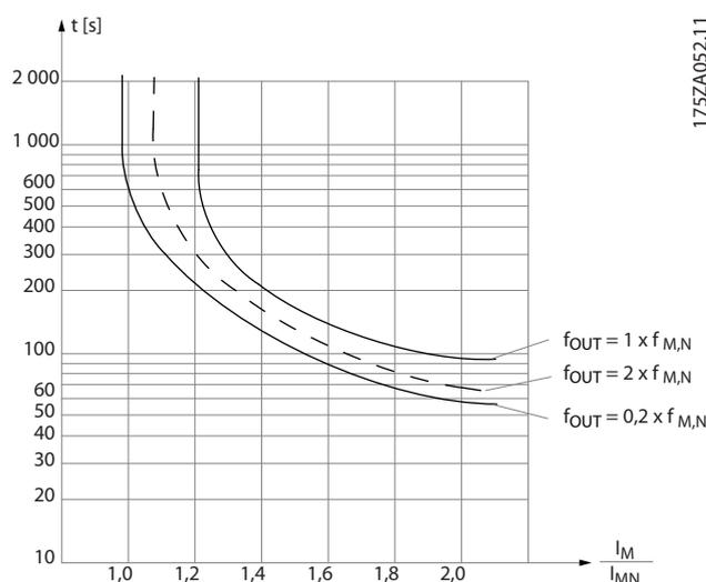
Illustration 2.40 L'axe des abscisses indique le rapport entre  $I_{\text{moteur}}$  et  $I_{\text{moteur nominal}}$ . L'axe des ordonnées représente le temps en secondes avant que l'ETR ne se déclenche et fasse disjoncter le variateur de fréquence. Ces courbes montrent la vitesse nominale caractéristique à deux fois et à 0,2 fois la vitesse nominale.
