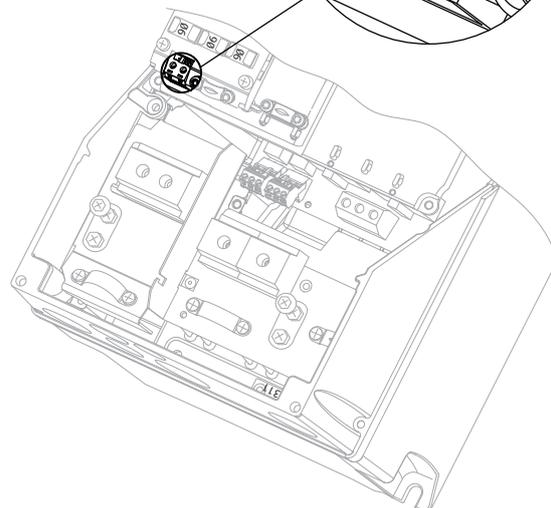
**Illustration 3.11 Connexion à l'alimentation de secours 24 V (A5-C2).**
