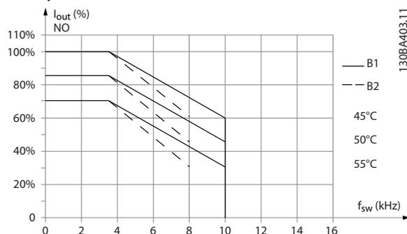
Illustration 9.10 Déclassement de  $I_{sortie}$  pour différentes  $T_{AMB, MAX}$  pour protections de types B1 et B2, utilisant SFAVM en mode surcharge normale (surcouple de 110 %)
