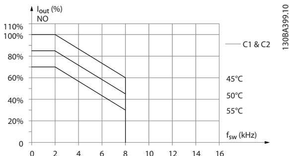
Illustration 9.18 Déclassement de I<sub>sortie</sub> pour différentes T<sub>AMB</sub>, MAX pour protections de types C1 et C2, utilisant SFAVM en mode surcharge normale (surcouple de 110 %)
