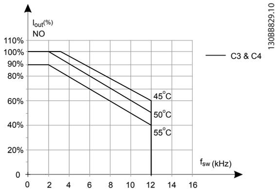
Illustration 9.17 Déclassement de I<sub>sortie</sub> pour différentes T<sub>AMB</sub>, MAX pour protections de types C3 et C4, utilisant 60° AVM en mode surcharge normale (surcouple de 110 %)
