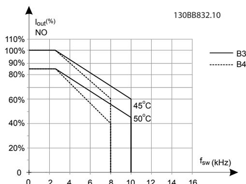
Illustration 9.11 Déclassement de  $I_{sortie}$  pour différentes  $T_{AMB, MAX}$  pour protections de types B3 et B4, utilisant SFAVM en mode surcharge normale (surcouple de 110 %)
