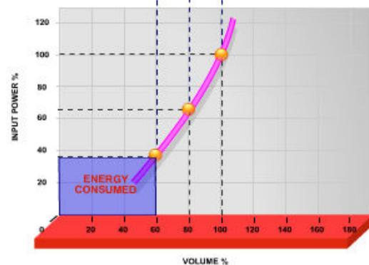
Illustration 2.9 Lors de l'utilisation d'un variateur de fréquence pour diminuer la capacité du ventilateur à 60 %, des économies d'énergie de plus de 50 % peuvent être obtenues dans des applications typiques.
