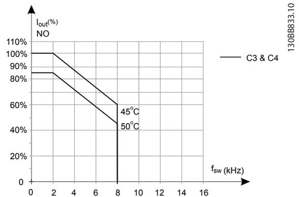
Illustration 9.19 Déclassement de I<sub>sortie</sub> pour différentes T<sub>AMB</sub>, MAX pour protections de types C3 et C4, utilisant SFAVM en mode surcharge normale (surcouple de 110 %)
