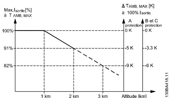
**Illustration 9.24 Déclassement du courant de sortie en fonction de l'altitude à  $T_{AMB, MAX}$  pour des protections de types A, B et C. À des altitudes de plus de 2 000 m, merci de contacter Danfoss en ce qui concerne la norme PELV.**
