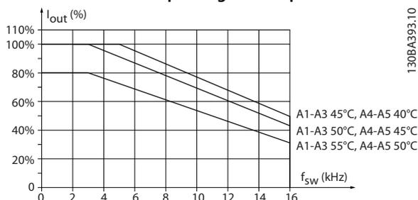
Illustration 9.3 Déclassement de  $I_{\text{sortie}}$  pour différentes  $T_{\text{AMB}}$ , MAX pour protection de type A, utilisant 60° AVM
