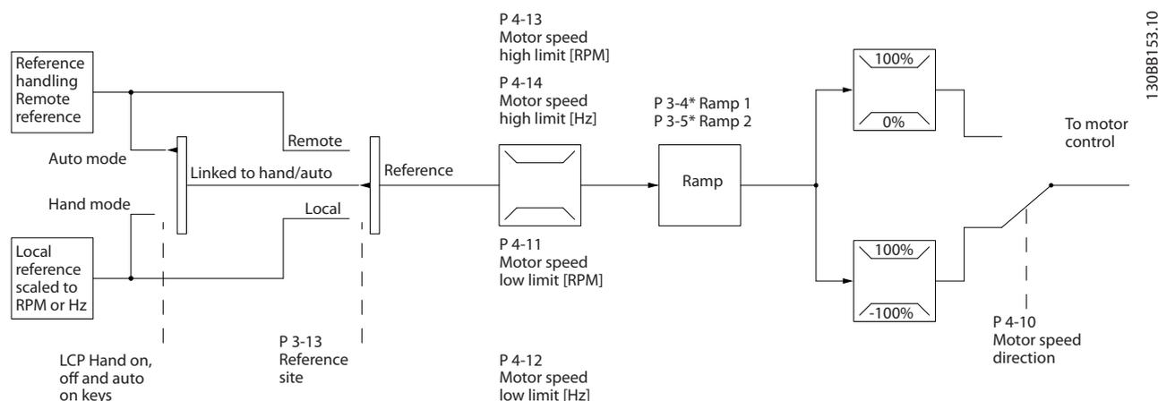
Illustration 2.24 Structure en boucle ouverte
