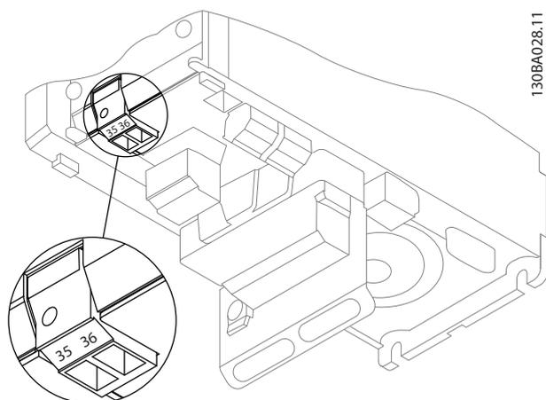
**Illustration 3.10 Connexion à l'alimentation de secours 24 V (A2-A3).**
