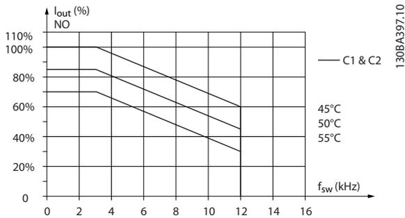
Illustration 9.16 Déclassement de I<sub>sortie</sub> pour différentes T<sub>AMB</sub>, MAX pour protections de types C1 et C2, utilisant 60° AVM en mode surcharge normale (surcouple de 110 %)
