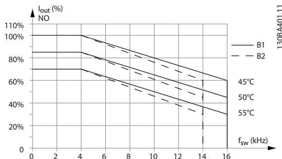
Illustration 9.8 Déclassement de  $I_{sortie}$  pour différentes  $T_{AMB, MAX}$  pour protections de types B1 et B2, utilisant 60° AVM en mode couple normal (surcouple de 110 %)
