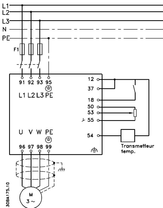
Illustration 2.31 Exemple de régulateur PID en boucle fermée
