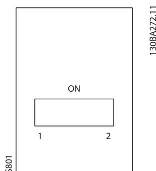
Illustration 8.3 Réglage d'usine du commutateur de terminaison
