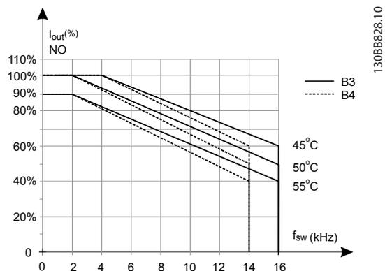
Illustration 9.9 Déclassement de  $I_{sortie}$  pour différentes  $T_{AMB, MAX}$  pour protections de types B3 et B4, utilisant 60° AVM en mode surcharge normale (surcouple de 110 %)
