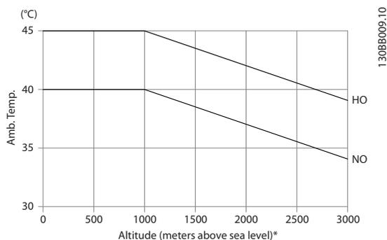
**Illustration 9.26 Exemple : à une altitude supérieure à 2 000 m et une température de 45 °C ( $T_{AMB, MAX} - 3,3$  K), 91 % du courant de sortie nominal est disponible. À une température de 41,7 °C, 100 % du courant de sortie nominal est disponible.**
