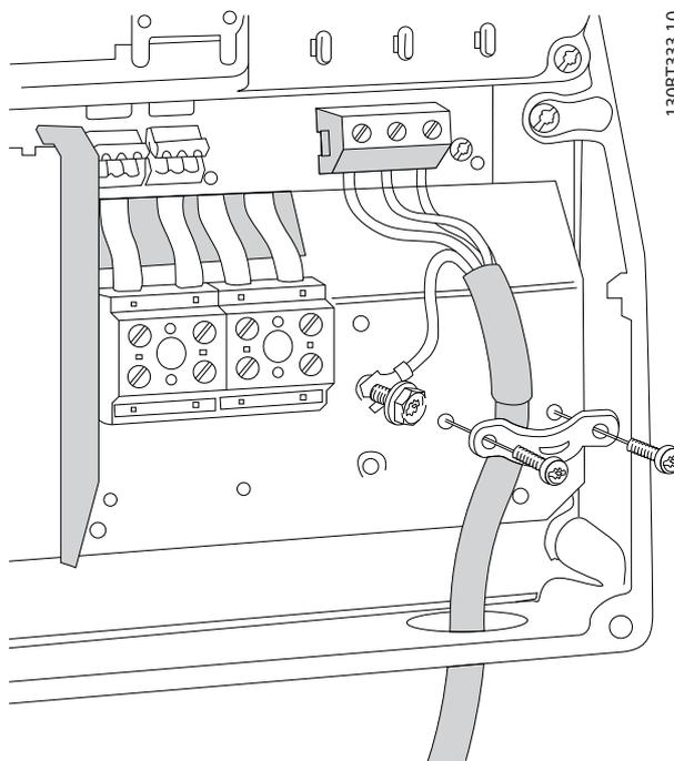
Illustration 6.15 Raccordement du moteur pour protections de types B1 et B2 (IP21/NEMA type 1, IP55/NEMA type 12 et IP66/NEMA type 4X)
