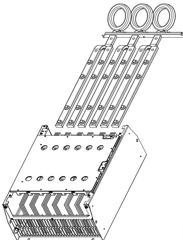
Illustration 12.3 Barres omnibus avec attaches de câble
