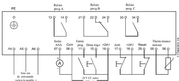
Illustration 4.1 Câblage vers les bornes de commande
