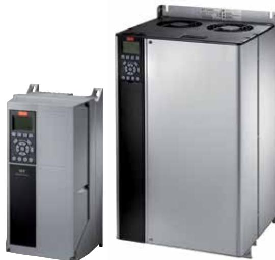
Les convertisseurs à contacts protégés avec protection nominale IP20 ou IP21 (à droite) sont destinés à un montage en armoire. Les convertisseurs étanches aux projections avec protection nominale IP54 ou IP55 (à gauche) sont conçus pour un montage mural ou sur châssis.
