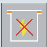
Avec la classe de protection contre l'inflammation « e », la protection consiste à empêcher un niveau d'énergie suffisant pour causer une étincelle.
