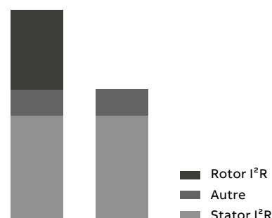
Pertes IM vs SynRM
